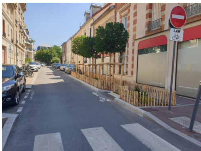
Illustration 47 : Bocages urbains installés en bordure de voirie pour recueillir les eaux pluviales Source : ©Vertuo
